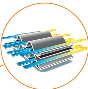
Détail d'une roue de déshydratante Seibu Giken. La multitude des canaux d'air permet d'extraire l'humidité avec une réelle efficacité.
