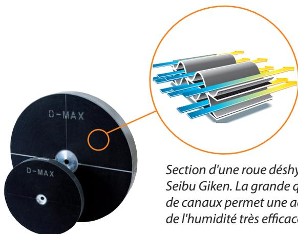
Section d'une roue déshydratante Seibu Giken. La grande quantité de canaux permet une adsorption de l'humidité très efficace.
